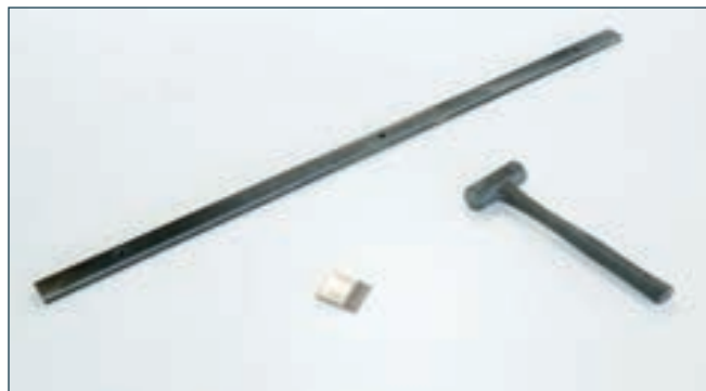
Előkészítés Szükséges szerszámok: egyenes él, puha gumikalapács, szétszerelő ék.
